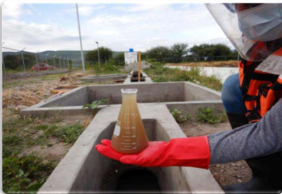
Foto 5. Se aprecia la coloración café-claro del agua residual en el pretratamiento posterior a la trampa de grasa.
