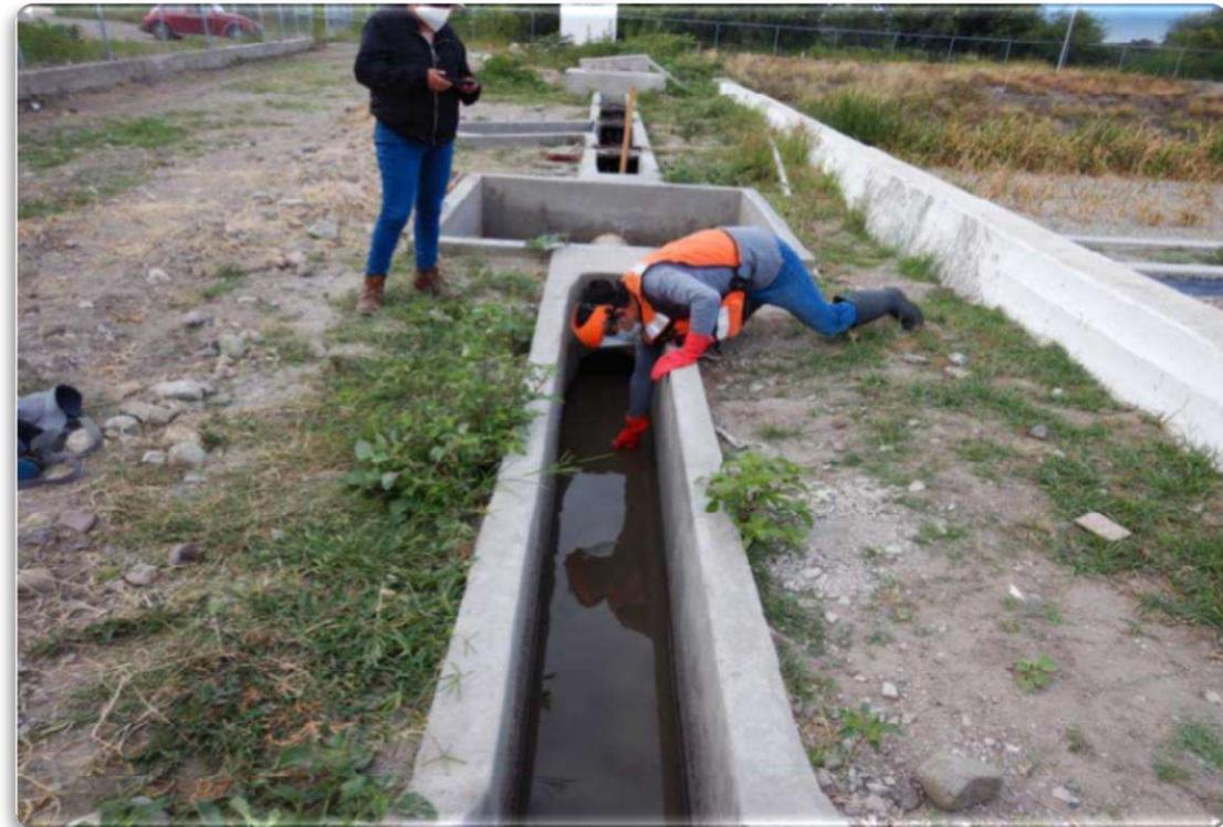
**Foto 4. Se observa la toma de Calidad de agua residual sobre el canal del pretratamiento con el Multiparámetro.**
